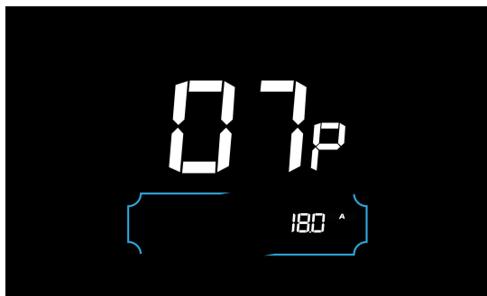
Фигура 6-8 Настройка на ограничението на тока на контролера
