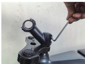
5. Затегнете страничния винт на стойката.
