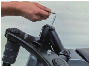
1. Развийте горния винт на кормилната стойка.
