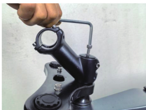
4. Завъртете стойката и затегнете горния винт.
