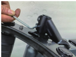
2. Развийте страничния винт на кормилната стойка.
