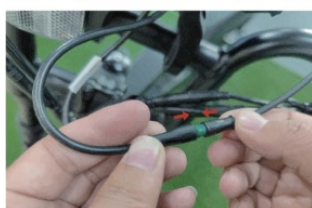
19)Свържете конекторите на кабелите както е показано със стрелки
