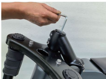
1.Отвийте винта от лапата
