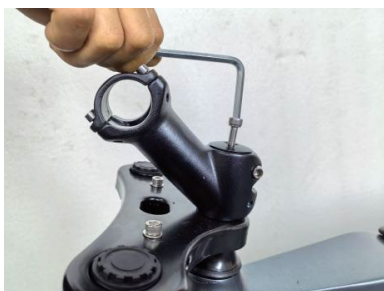
4.Завъртете лапата и затегнете горния винт.
