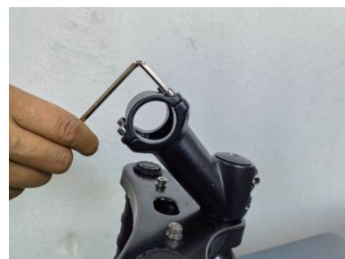
6.Отвийте винтовете на предната част на лапата.
