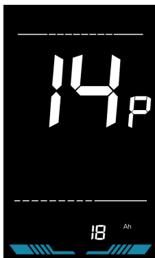
Фигура 6-14: Интерфейс за настройка на ограничението на тока на контролера
