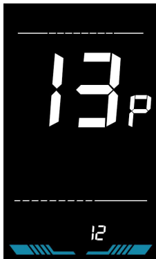
Фигура 6-13: Интерфейс за настройка на броя магнити за сензора на педалната асистенция
