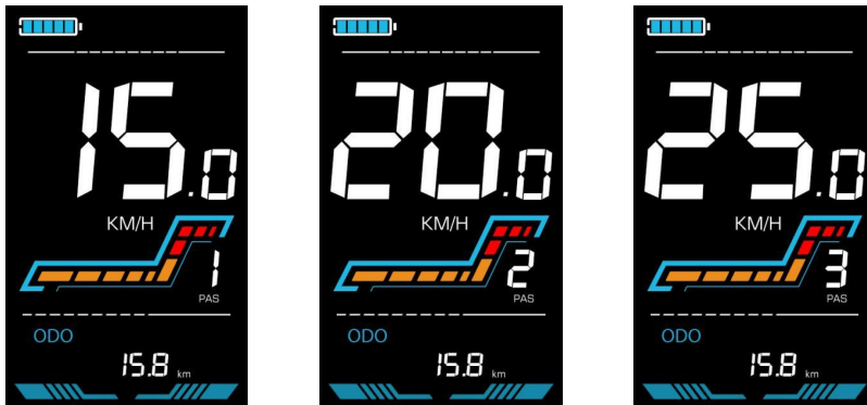
Фигура 5-4: Интерфейс на дисплея при промяна на нивата на подпомагане
