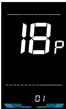
Фигура 6-18: Интерфейс за настройка за помощ при бутане с 6 km/h)
