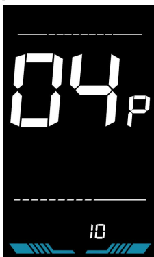
Фигура 6-4: Интерфейс за настройка на времето за автоматично заспиване
