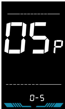
Фигура 6-5: Интерфейс за настройка на нивото на PAS)
