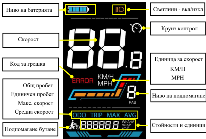
Фигура 4-1 YL90T-V функционална площ и разпределение
