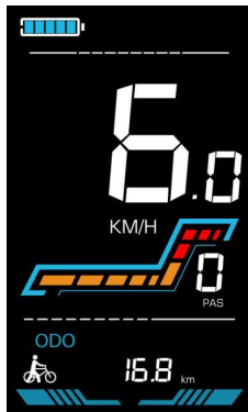
Фигура 5-2: Интерфейс на дисплея в режим за подпомагане при бутане
