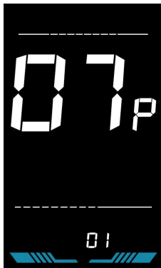
Фигура 6-7: Интерфейс за настройка на броя магнити за сензора за скорост
