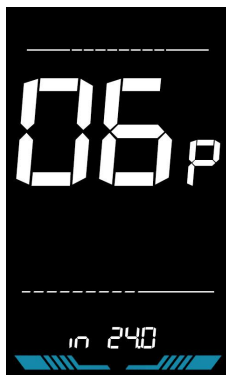
Фигура 6-6: Интерфейс за настройка на диаметъра на каплите
