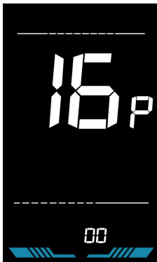
Фигура 6-16: Интерфейс за настройка за нулиране на пробег
