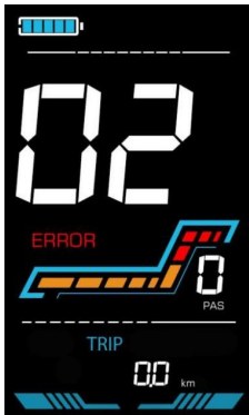
Фигура 5-6: Интерфейс за показване на код за грешка
