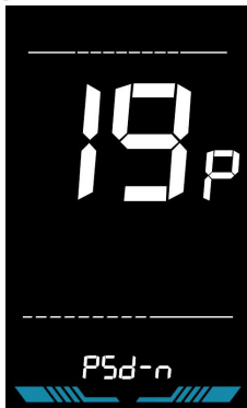
Фигура 6-19: Интерфейс за настройка на парола при включване
