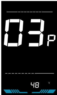
Фигура 6-3: Интерфейс за настройка на номиналното напрежение
