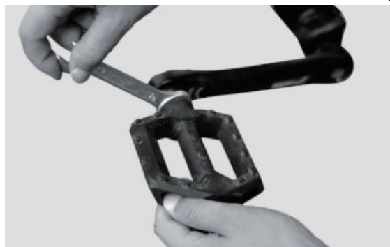
1.Педалите в опаковката имат означения „L” за ляв и „R” за десен педал съобразно страната, на която се монтира. 2.Левият „L” педал се завива ОБРАТНО на часовниковата стрелка, а десния „R” – ПО ПОСОКА на часовниковата стрелка.
