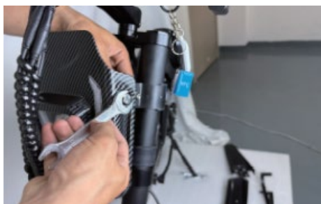
1.С осигурените инструменти развийте гайките
